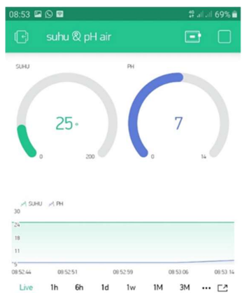
Gambar 8. Hasil Pengukuran Nilai Suhu dan Nilai pH Ditampilkan pada Blynk.
